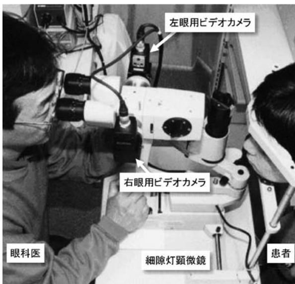
【図 2】 細隙灯顕微鏡（検査用顕微鏡）による 3D 動画の撮影
