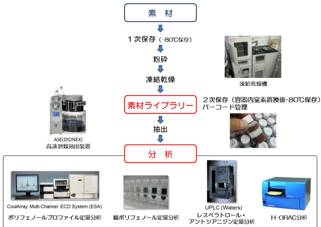
抗酸化機能分析研究センターの作業工程
