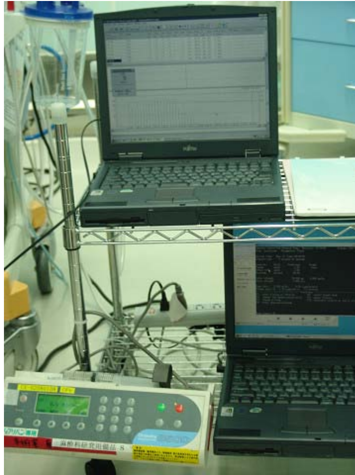
図9. コンピュータにSTANPUMPをインストールしてシリンジポンプをコントロールするとTCIも可能である。
