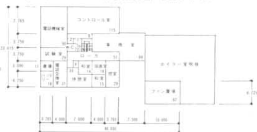
エネルギーセンター(中央機械室)2階646㎡
