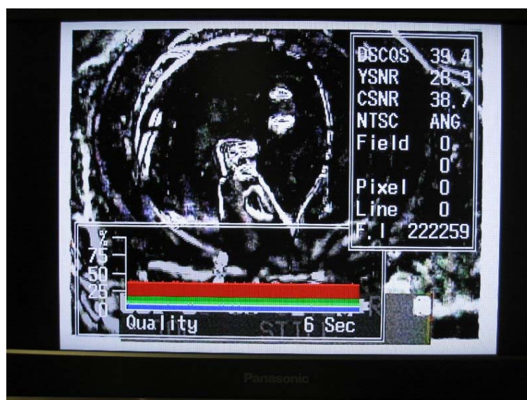
図 3.18 モニタに出力された画質測定結果の一例
