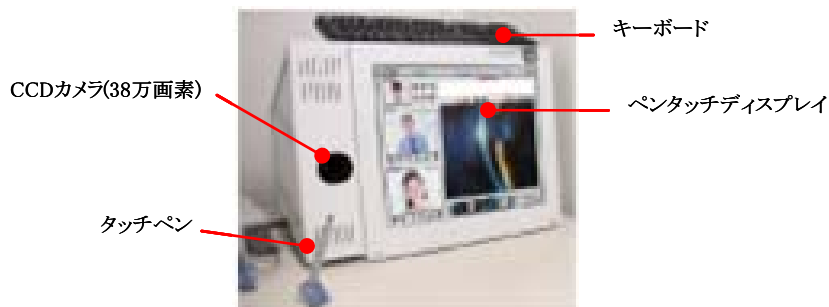
図 2.7 クライアント端末のハードウェア構成
