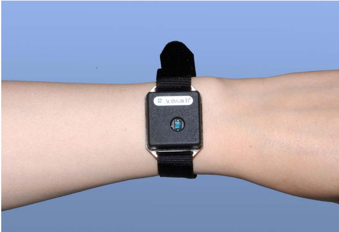
図1 アクティグラフ（米国ミニミッター社製アクティウオッチ） 体動のレベルと頻度に対応した信号を発生するアクセロメーターを内蔵し、アクティビティカウントとして記録する。
