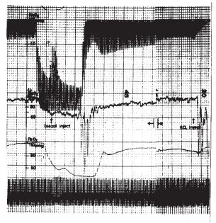
図3 北大応用電気研究所で行われた耳介型パルスオキシメーターの性能実験 上段からグロー放電式呼気ガス分析装置による 吸入気酸素濃度の連続記録 中段はパルスオキシメーターの出力 下段は酸素 Pt 電極の出力 (大腿動脈に直接刺 入)
