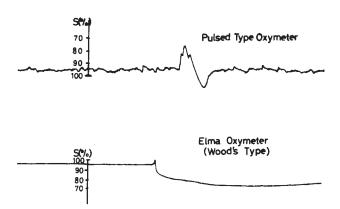
**図2** イヤピースをずらした際に生じた基線の復帰状 況
